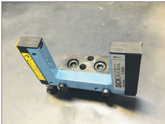
En hesteskosformet sensor er placeret på operterboret for at sikre at robotten holder emnet det rette sted.
